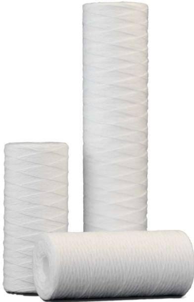
Die WP-Wickelkerzen werden in einem Spezialwickelverfahren aus dem Grundwerkstoff Polypropylen hergestellt. Dadurch können diese Filterelemente für fast alle neutralen und aggressiven Medien eingesetzt werden.
